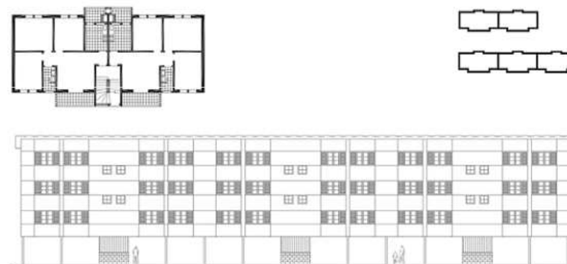
Figura 08 – Planta Baixa e Elevação da tipologia de uma escada para 2 unidades. Fonte: "Análise Tipológica da Produção de Habitação Econômica no Brasil (1930-1964)"
